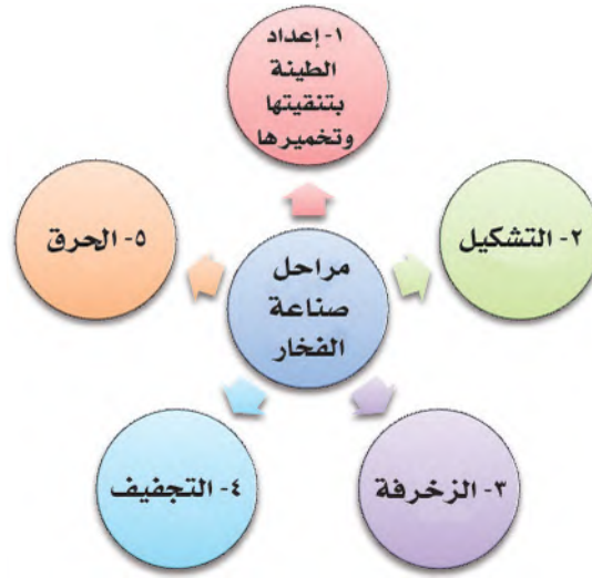
الشكل (٢١٠) المراحل الأساسية لصناعة الفخار
