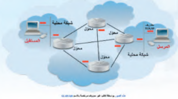
شكل (1-11) نقل وتبادل المظروف بين المحولات باستخدام مداولات (TCP/IP)
