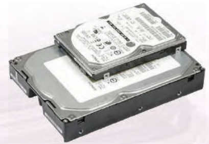
شكل (10-6): محركات الأقراص الصلبة (Hard Drive) بمقاسيها (3.5) بوصة، و(2.5) بوصة
