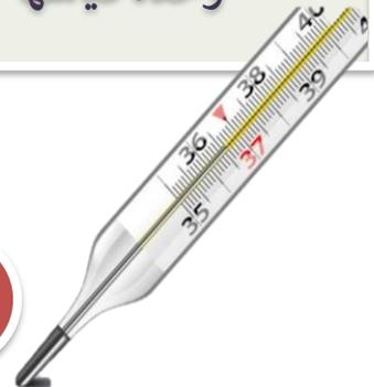
يوجد داخل مقياس الحرارة سائل ( كحول او زئبق ) وعندما يسخن المقياس تتحرك جسيمات السائل بسرعة ويتمدد السائل داخل أنبوب المقياس
