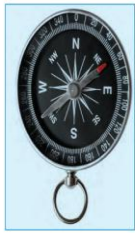
أبرة البوصلة المغناطيسية تحدد اتجاه القطب الشمالي المغناطيسي للأرض.
