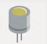
دايود حساس للضوء (Photodiode)
