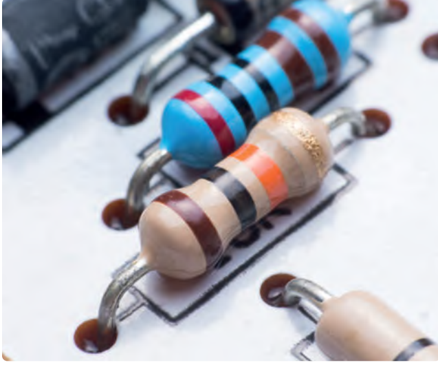
شكل 2.1: صورة حقيقية للمقاومة
