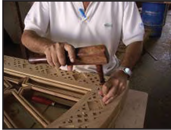
(١): استخدام المدق الخشبي، وهي الأداة الصحيحة.
