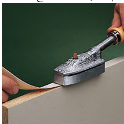
الشكل ( ٦٣ ) : وتستخدم أيضاً لتغطية مساحات صغيرة كحواف الأخشاب . وبتنوع أنواع الأخشاب وألوانها، تتنوع قشرة الخشب . لذا فإنها مناسبة جداً لتزيين الأبواب، والصناديق الخشبية، والطاولات . هذا بالإضافة إلى إمكانية عمل لوحات فنية باستخدامها .
