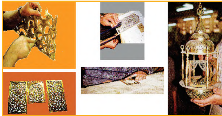
الشكل (٨): طرق استخدام أزاميل ومنشار المعادن
