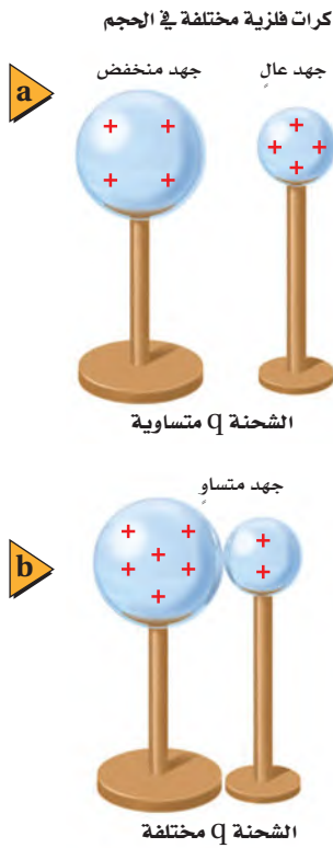
■ الشكل 3-12 تنتقل الشحنات من الكرة ذات الجهد الأعلى إلى الكرة ذات الجهد الأخفض عند تلامسهما، ويستمر انتقال الشحنات إلى أن ينعدم فرق الجهد بينهما.
