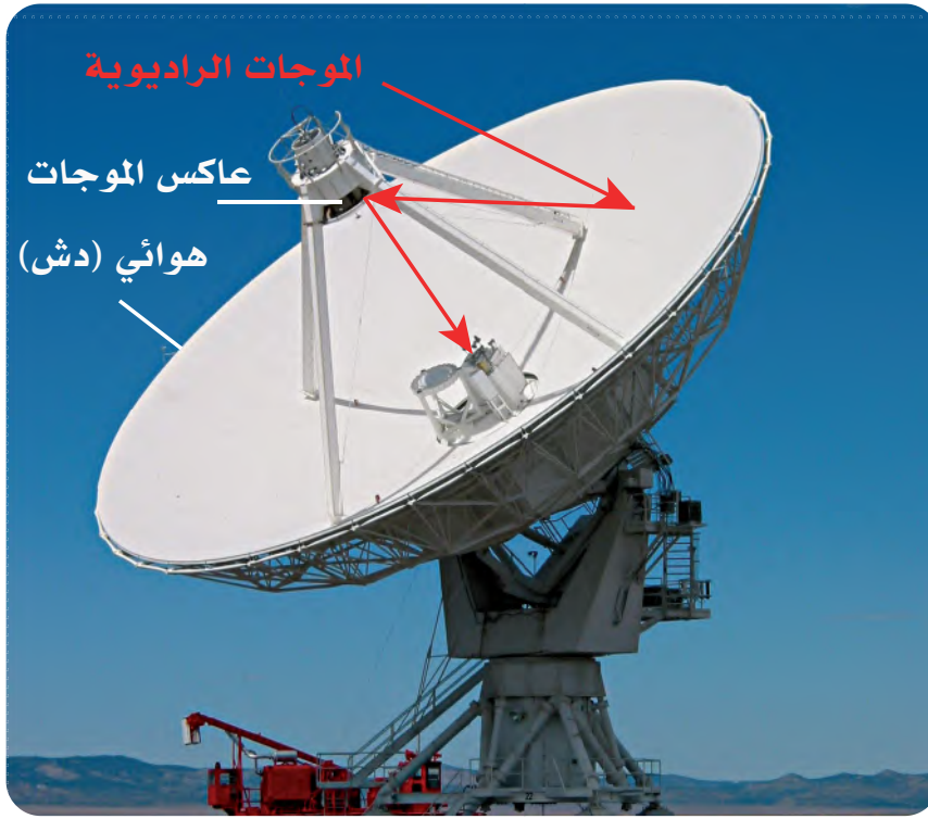
الشكل 14-3 تركيب المنظار الراديوي.
