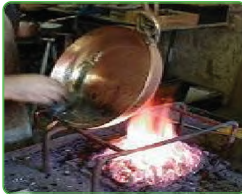
الشكل (٢٧): التخمير «تسخين المعدن لإكسابه اللدونة».
