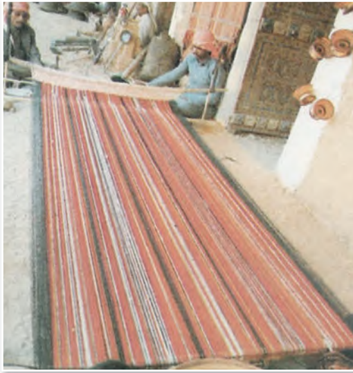
الشكل (٩): نول أرضي لإنتاج قطعة كبيرة.
