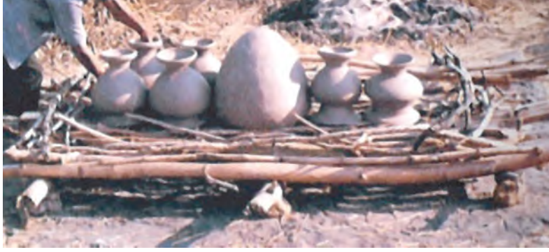
الشكل (١٥) : الطريقة التقليدية لتجفيف البطانات.
