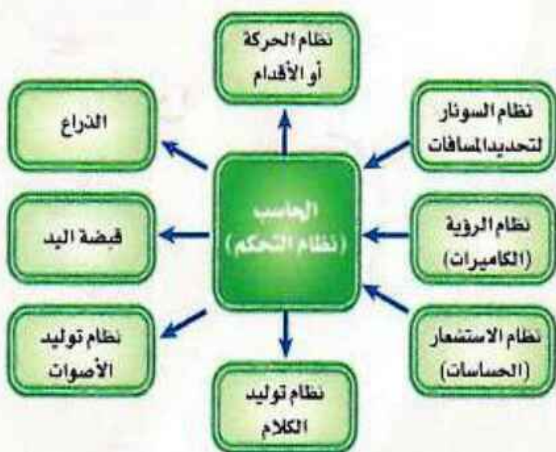
شكل (٩-٤): النظم الفرعية التي يتكون منها الروبوت
