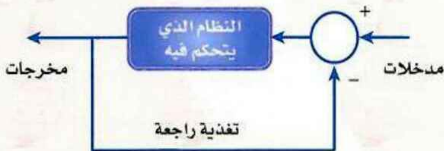
شكل (٨-٤): المكونات الرئيسية في نظام التحكم ذي الدائرة المغلقة
