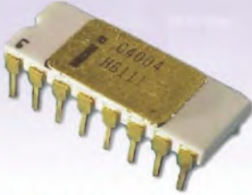
شكل (٣-٦): المظهر الخارجي للمعالج الدقيق (4004)
