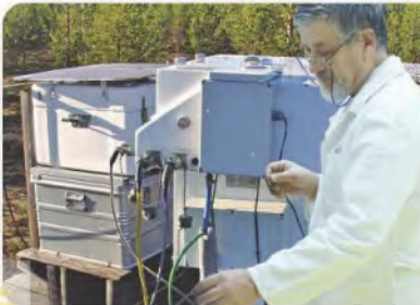
الشكل 4-1 يستعمل العلماء أنواعاً مختلفة من الأجهزة، ومنها مطياف بريور لقياس كمية غاز الأوزون في الجو.
