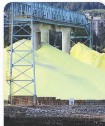
الشكل 5-9 الكبريت يتم استخراج الكبريت من مننوجات البتروك بواحدة عمليات كيميائية، كما يستخرج بدفع الماء الساخن إلى أماكن تجمعها تحت الأرض، فيضخ الكبريت السائل إلى السطح.
