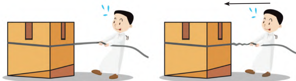
الشكل ١٦ إنحناء الحبل عند تعرضها لقوة الدفع.
