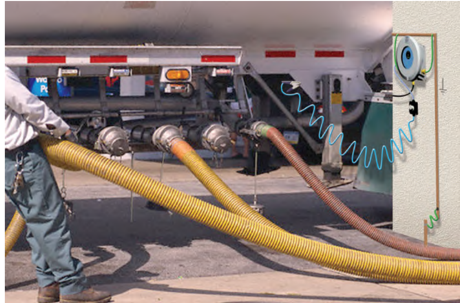
الشكل 13-6 سلك التأريض المتصل بصهريج نفط يمنع اشتعال بخار البنزين.
