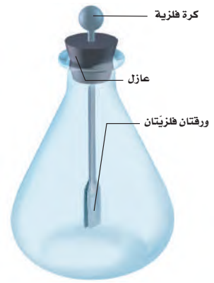
■ الشكل 5-8 الكشاف الكهربائي؛ جهاز يستخدم للكشف عن الشحنات الكهربائية. في الكشاف الكهربائي المتعادل تكون الورقتان معلقتين رأسياً بحرية، وتلامس إحدهما الأخرى.
