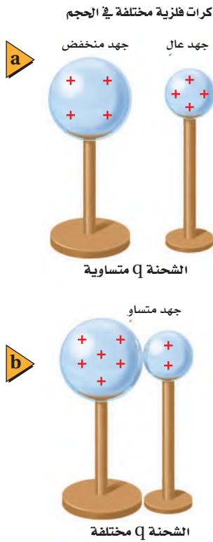
الشكل 6-12 تنتقل الشحنات من الكرة ذات الجهد الأعلى إلى الكرة ذات الجهد الأخفض عند تلامسهما، ويستمر انتقال الشحنات إلى أن ينعدم فرق الجهد بينهما.
