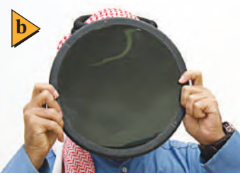
■ الشكل 18-1 عندما يتم ترتيب مرشحي استقطاب بحيث يكون محورا استقطابهما متوازيين، تنفذ من خلالهما أكبر كمية من الضوء (a). ولن ينفذ الضوء من خلال مرشحي الاستقطاب إذا تم ترتيبهما بحيث يكون محورا استقطابهما متعامدين (b).
