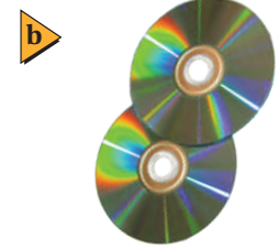
■ الشكل 12-4 جوهرة مصنوعة في صورة محزوز نفاذ تنتج أطيفاً ضوئية (a). تُعد الأقراص المدمجة محزوزات انعكاس؛ إذ تكوّن نمط طيف الحيود عندما يسقط عليها ضوء أبيض (b).
