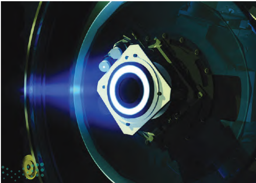
■ الشكل 7-2 تتأين ذرات الزينون الموجودة في المحرك الأيوني عن طريق قذفها بالإلكترونات، ثم تسرع أيونات الزينون الموجبة إلى سرعات عالية.
